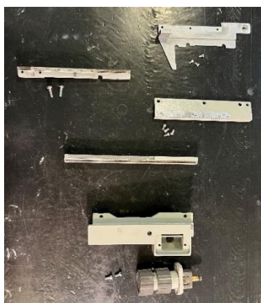
شکل ۳: قطعه های باز شده خط کش متحرک.
