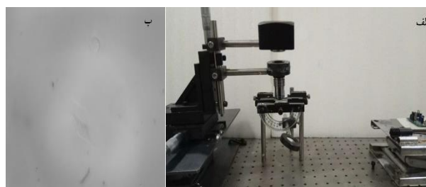
شکل ۵: تصاویر حاصل از پژوهش پیشین دانشگاه الزهراء (الف) چیدمان ریزبین فلورسانس بازتاب داخلی کلی بر پایه منشور، (ب) تصویر سلولی حاصل از چیدمان
